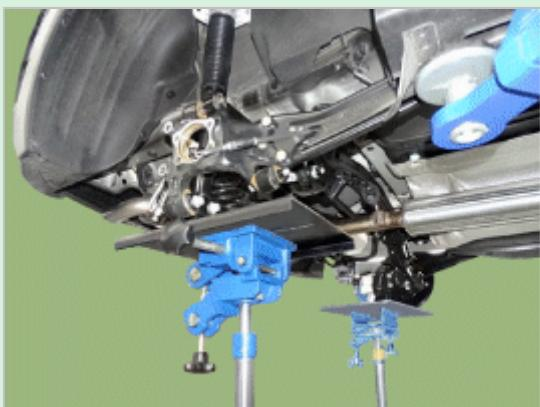
4. 拧下固定螺栓和螺母，并拆卸后下臂。
